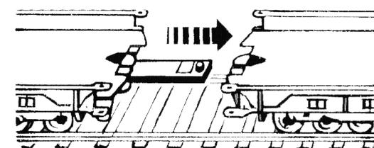
Niederflurwagen zusammenschieben bis Zapfen der Kuppelstange fest einrasten.
