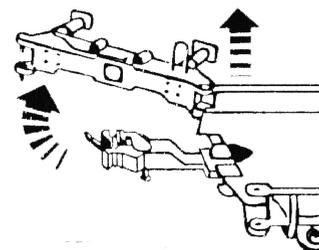
Zum Beladen der Niederflurwagen über Auffahrrampe, Pufferbohle seitlich ausschwenken oder ganz entfernen.
